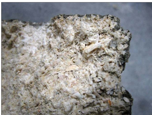
تصویر ۴. سطح مقطع سنگ لوماشل معدن هُلر در گهان استحکام بخشی با رزین اپوکسی
