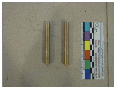
تصویر (۱): الکترودهای تهیه شده برای برش کوپن‌ها
