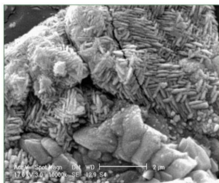
تصویر (۸): SEM از نمونه شاهد در برابر محلول خورنده سدیم کلرید ۰/۵M
