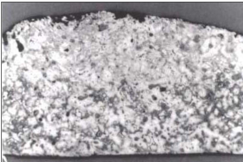
شکل ۹- تصویر متالوگرافی مربوط به یک دوات متعلق به دوره اسلامی (اواخر قرن ۱۲ و اوایل ۱۳ م) که به روش ریخته‌گری ساخته شده است و در آن حفره‌های ناشی از ریخته‌گری دیده می‌شود (Scott 1991, 87).
