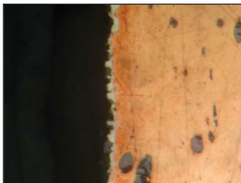
شکل ۱۰- تصویر میکروسکوپی مقطع بدنه ظرف مسی قلع اندود تاریخی، بزرگنمایی X ۵۰۰، فاز \eta با رنگ روشن
