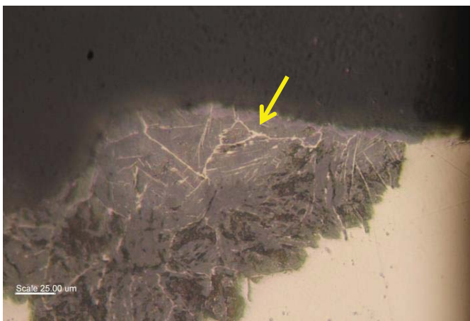
شکل ۱۲- تصویر میکروسکوپ نوری مقطع نمونه مربوط به مشبک فولادی متعلق به دوره صفوی که در آن خوردگی یک فاز و باقی‌ماندن فاز دیگر مشاهده می‌شود.
